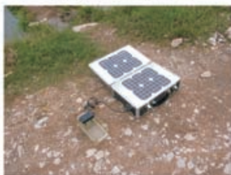
正在使用太陽能發電器測試水質
