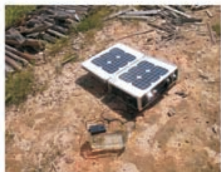
利用太陽能設備快速檢測水質
