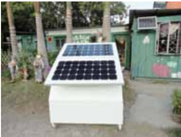
流動太陽能發電器
